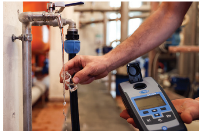
| Dodatno vsakodnevno ročno preverjanje motnosti snovi v surovi vodi (v primeru, da bi tehnologija zatajila)
