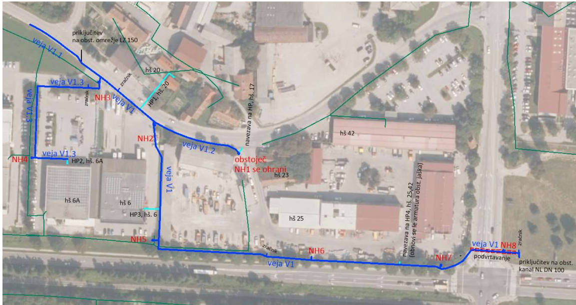
Slika: Predviden vodovod in obstoječe Telemach omrežje
