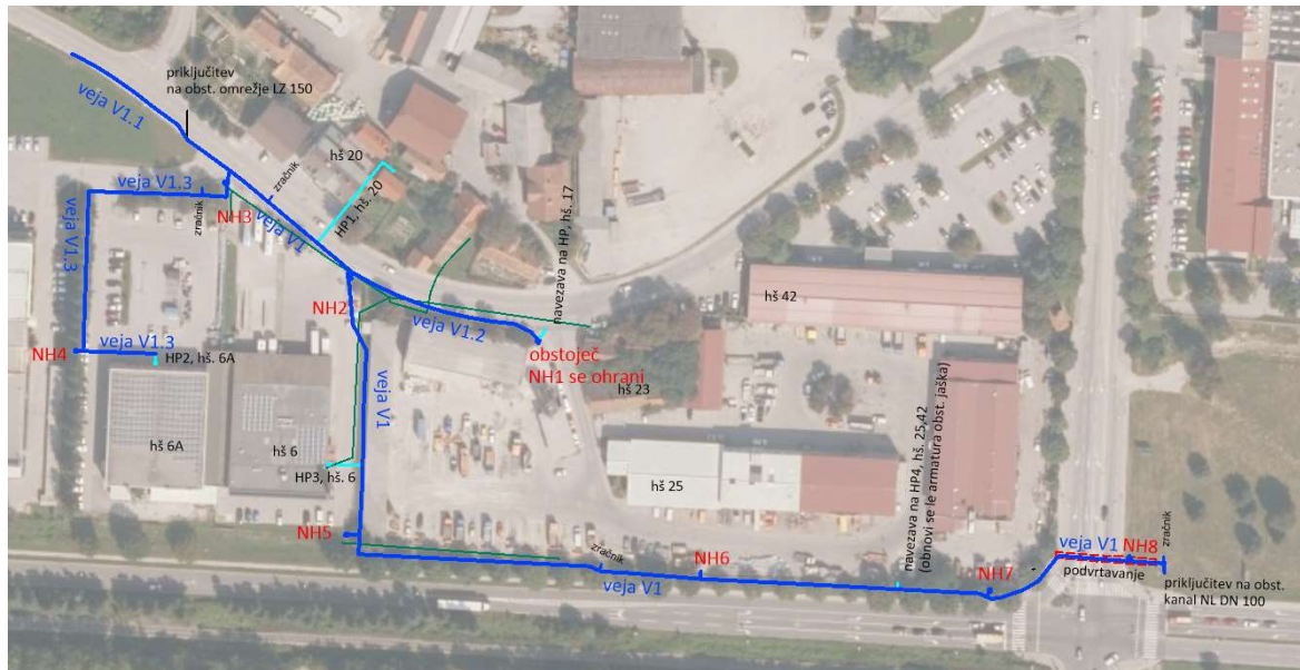
Slika: Predviden vodovod in obstoječe Telekom omrežje
