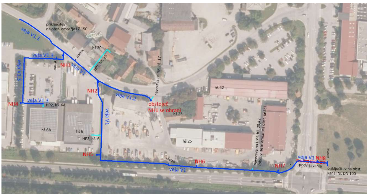
Slika: Predvidena obnova vodovoda
