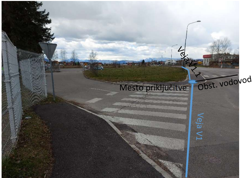
Slika 1: Mesto priključitve predvidenega vodovoda na obstoječe omrežje
